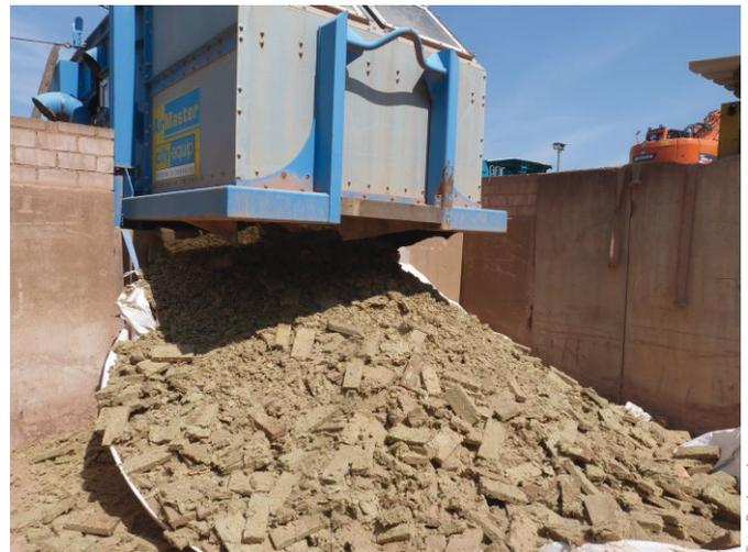
**Bild 6** Durch Windsichtung abgetrennte Dämmstofffüllung [9]
