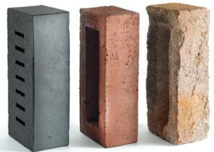
▲ Strangpress-, Wasserstrich-, Handformziegel
